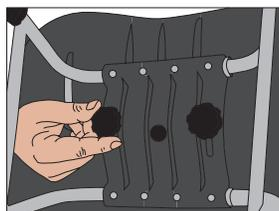
19. シート面の傾きは裏側のナットをゆるめ調整してください。乗った状態でも変更可能です。
