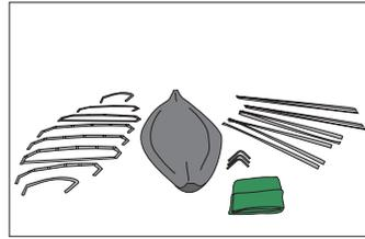
2. フォームマットを広げ、クロスリブを大きさに従って並べます。次にキールロッドやフレーム、ガンネルを組み立てておきます。
