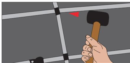
14. カヌーに乗り込み、斜めの状態にセットしたクロスリブを両手で垂直になるよう引き込んで行きます。各コネクターが最適な位置になるよう、何度もハンマーで軽く叩きながら戻したり引き込んだりして調整していきます。ここが最も力のいる作業です。
