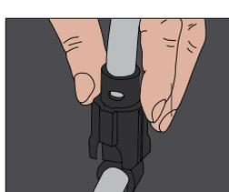
18. インナーフレームにシートをはめ込んでいきます。ロッククリップを下に押し込み位置を確定します。
