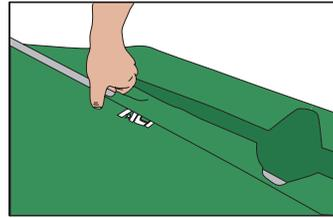
3. スキン(船体布)を広げ、ガンネルを差し込みます。挿入する側のスキン面を上にし、回しながら差し込んでいくとスムーズに入っていきます。ロッドの両端は外に出た状態にて均等の長さで止めてください。
