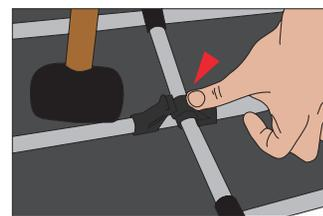
15. センター側から順に残りのクロスリブをインストールしたらインナーフレームの各ロッドクリップを留めていきます。カチッとするまで回しましょう。
