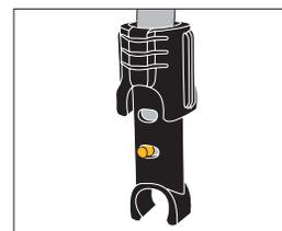
20. クリップを上下に動かせばシートの高さも三段階にて調整出来ます。
