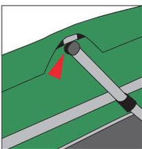
13. 最も幅広のセンタークロスリブからインストールしていきます。ガンネルの2つのOリングの間にクリップが噛むよう位置づけします。
