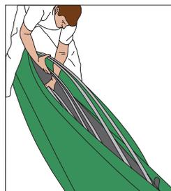
10. システムの一番上のフックにウオーターラインフレーム(最も長いフレーム)を取り付けデッキ内に押し込んでおきます。
