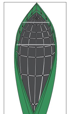
16. キールロッドの弧に偏りが出ないように各連結部分を回し調整します。これにてフレームの完成です。
